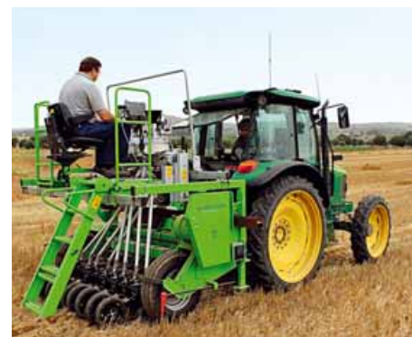
Seminatrice sperimentale parcellare Wintersteiger Plotseed XXL durante la preparazione delle prove
