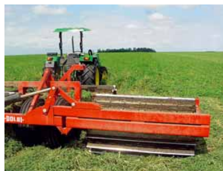
L'attrezzo che schiaccia la copertura vegetale e prepara il suolo alla semina su sodo
